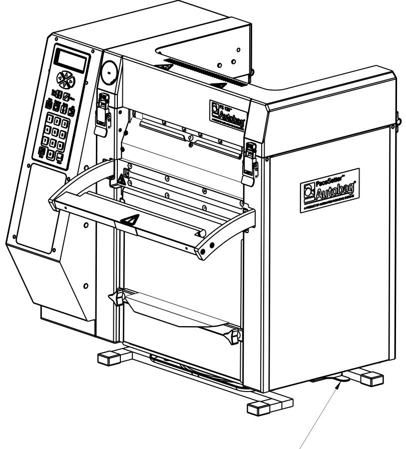
MACHINE PIVOT LOCK/RELEASE----
